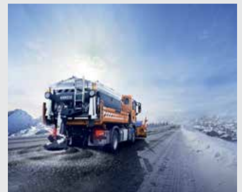
Bei dem Streuautomaten Phoenix Electra ersetzen bürstenlose Elektromotoren den herkömmlichen Hydraulikantrieb.
